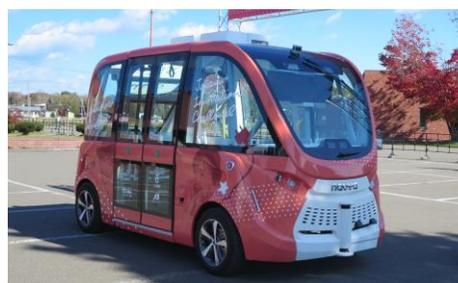
最高走行速度 15km/h(第一方向 直線ルート)
