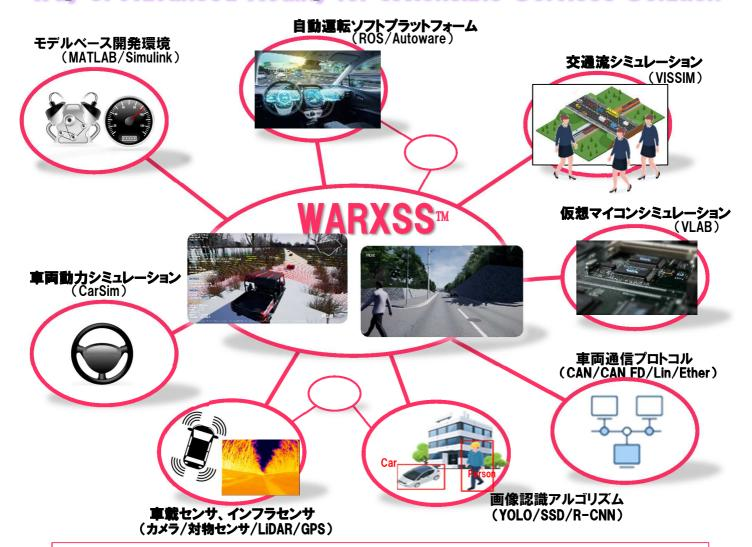
近年、急速な広がりを見せている運転支援システムや自動運転技術では、自車両の状態だけでなく、他車両、歩行者、標識などの外界環境の状況をセンシングし、 車両制御へ反映しています。また、自車両に搭載されたセンサのみでなく、インフラや他車両と通信を用いて連携するシステムが増えています。このようなシステムでは、 想定されるロケーション、シチュエーション、条件を網羅して評価する必要があり、網羅対象には外界環境や通信相手も考慮する必要があります。そのため、評価の 項目数は指数関数的に増加しています。
