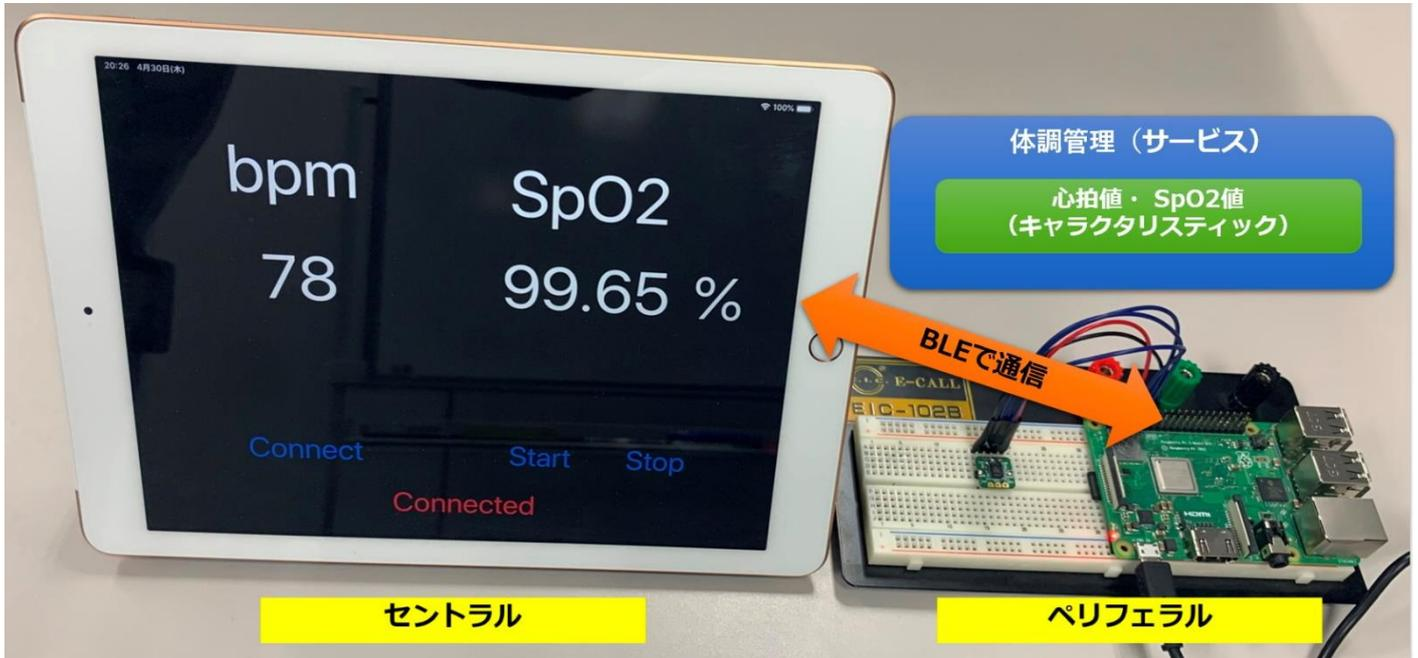
本システムでは上記のようになりますが、他に Raspberry Pi へ温度センサを取り付けることで、体温も同時に計測するということが可能です。その場合は体温値というキャラクタースティックを実装すれば BLE 通信で iPad へデータを送ることが可能になります。
